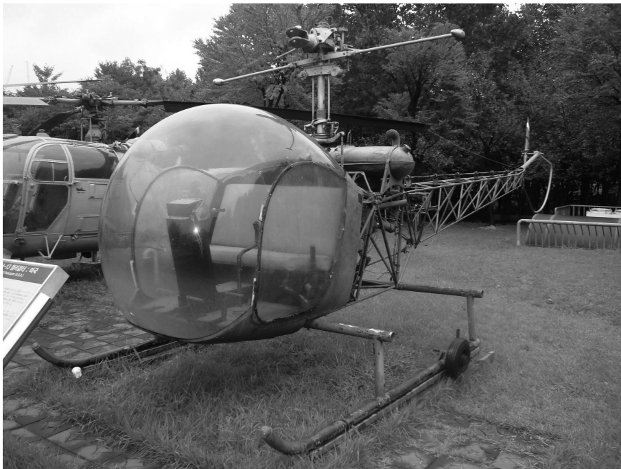
FIGURA 7.28 – HELICÓPTERO LEVE DE OBSERVAÇÃO H-13, UTILIZADO PRINCIPALMENTE PARA OBSERVAÇÃO DO FRONT
